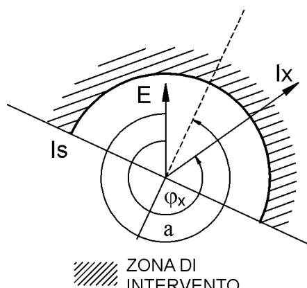
L'elemento opera semplicemente da supervisore della direzione della corrente
