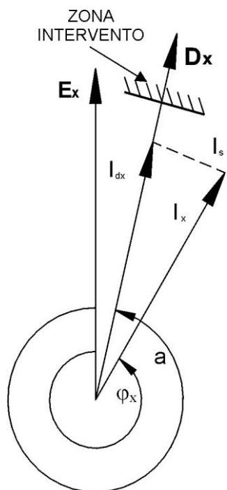
L'elemento di protezione funziona in modo totalmente direzionale e misura la componente "Idx" della corrente di ogni fase sull'asse orientato secondo l'angolo [a].
