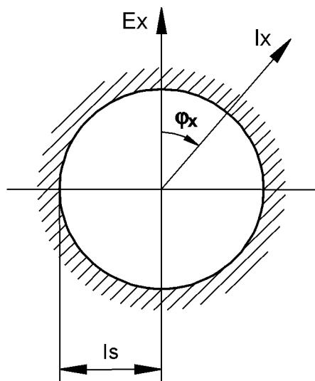
L'elemento di sovrafflussione opera in modo non direzionale quando  $I_x \geq [I_s]$  indipendentemente dallo sfasamento  $\varphi_x$
