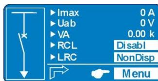
Nella schermata principale (vedi figura) vengono visualizzati i seguenti parametri "RCL" e "LRC" che indicano sia lo stato attuale della richiusura "RCL", e dell'ultima richiusura effettuata "LRC".
