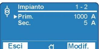
• Scegliere “**Prim.**” per modificare il valore primario del TA di Fase, o tramite il pulsante “**Scorrimento -**” scegliere “**Sec.**” per modificare il valore secondario del TA di Fase.
