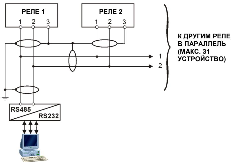
Для увеличения расстояния или для подключения до 250 реле, рекомендуется применение оптической линии связи.
