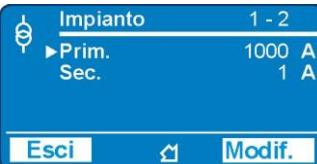
• Scegliere “**Prim.**” per modificare il valore primario del TA di Fase, o tramite il pulsante “**Diminuisce**” scegliere “**Sec.**” per modificare il valore secondario del TA di Fase.
