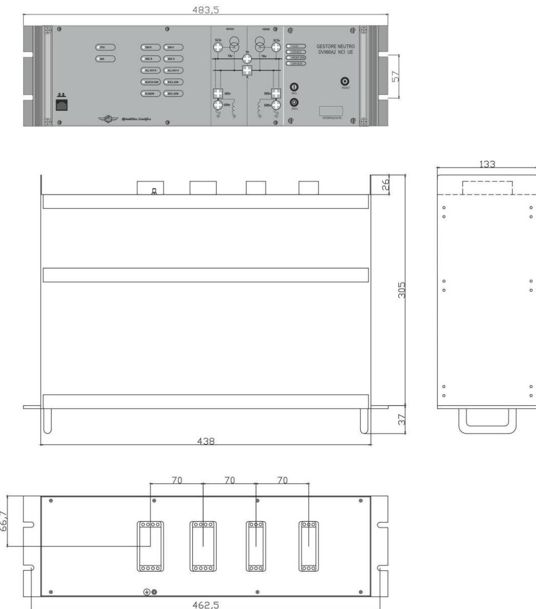
Il rack è del tipo unificato da 19", altezza 3U, due maniglie anteriori per la presa e due roll-bar posteriori per protezione dei connettori di campo. La costruzione è metallica, con l'impiego di alluminio e ferro. I materiali principali sono: AS63A; Aluzink P02-B500. Tutte le parti metalliche sono esenti da corrosione.
